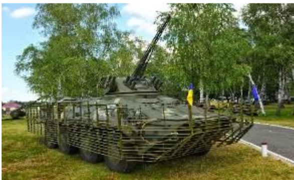
Рисунок 9 – бронетранспортер БТР-3Е та БТР-4Е з протикумулятивним екраном в районі ООС (раніше АТО).
