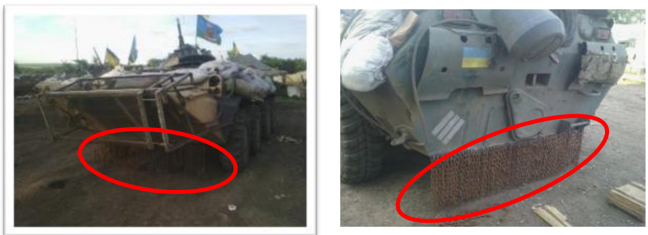
Рисунок 6 – приклад захисту від рикошетного вогню в районі ООС (раніше АТО).
