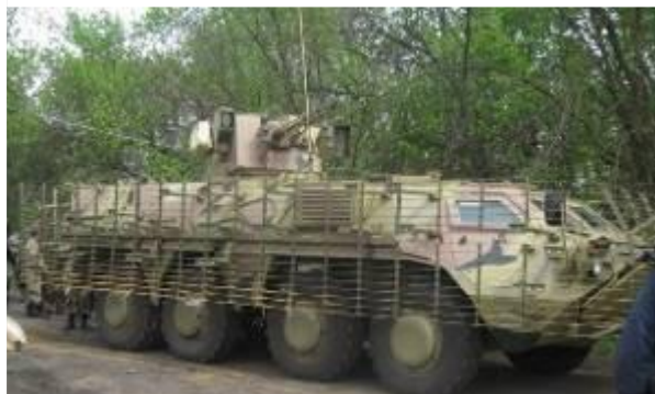
Рисунок 9 – бронетранспортер БТР-3Е та БТР-4Е з протикумулятивним екраном в районі ООС (раніше АТО).
