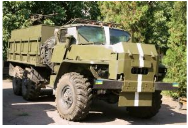
Рисунок 3 – приклади підвищення живучості вантажних автомобілів та захисту особового складу на початку Антитерористичної операції на сході України в 2014 році.
