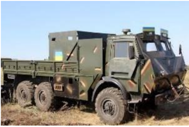
Рисунок 3 – приклади підвищення живучості вантажних автомобілів та захисту особового складу на початку Антитерористичної операції на сході України в 2014 році.
