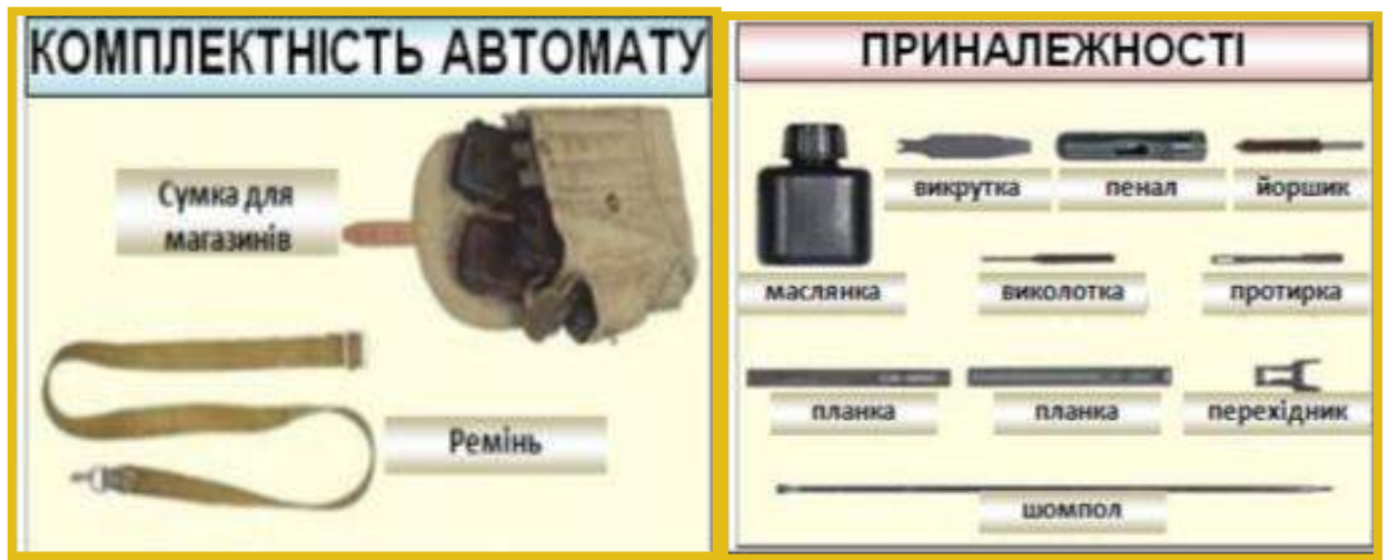
Рисунок 3 - комплектність та приналежність автомата Калашникова.
